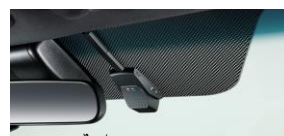
หมายเลขไหล่ 08E30-PL2-700 ติดตั้งในรถรุ่นเช่าเกินรถ
